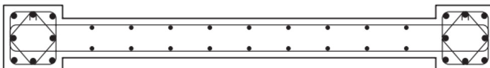
(b) Parede com elemento de contorno ampliado.
