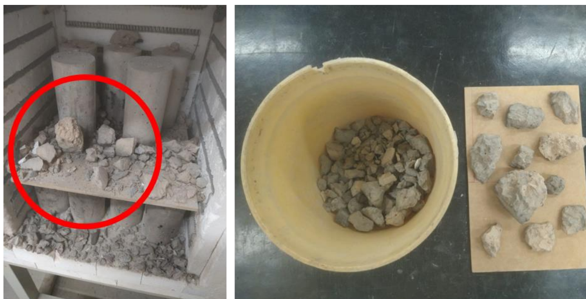
Figura 28 - Registro do efeito explosivo em amostra exposta à temperatura de 600°C.
