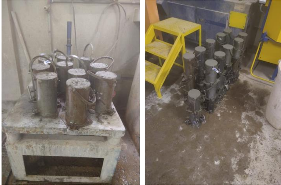
Figura 17 - Adensamento através de mesa vibratória.
