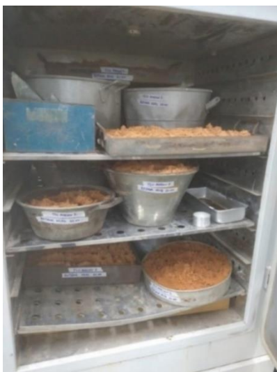
Figura 12 - Retirada da umidade dos agregados utilizados.
