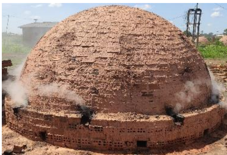
Fotografia 2 – Forno de tijolos do tipo meia-laranja.
