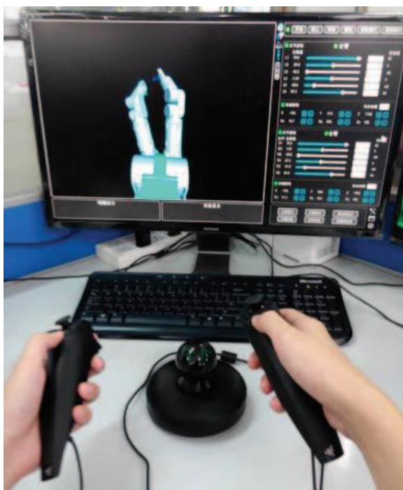
Figura 8 – Interação do operador com dois braços robóticos através do controle com sensores de movimento Razer Hydra.
