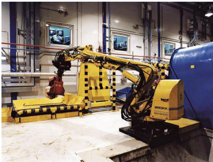
Figura 3 – Robô BROKK operando no sítio nuclear de Sellafield, Reino Unido.
