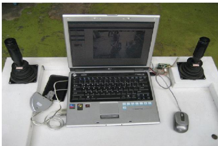
Figura 9 – Componentes da estação de operação remota da escavadeira.
