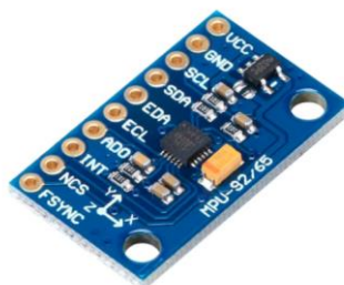
Figura 20 – MPU-9250, integrado no módulo de desenvolvimento GY-9250.
