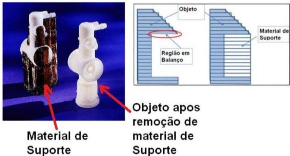
Figura 4 - Representação de material de suporte para FDM
