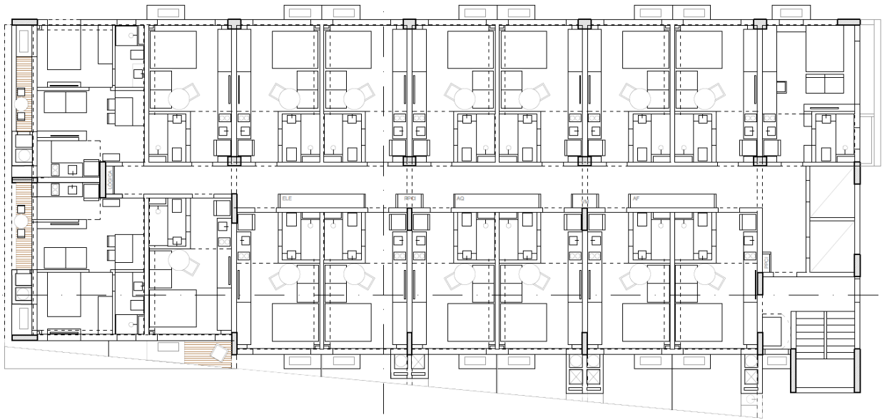
Figura 9 - Planta baixa do pavimento Tipo – Andares pares
