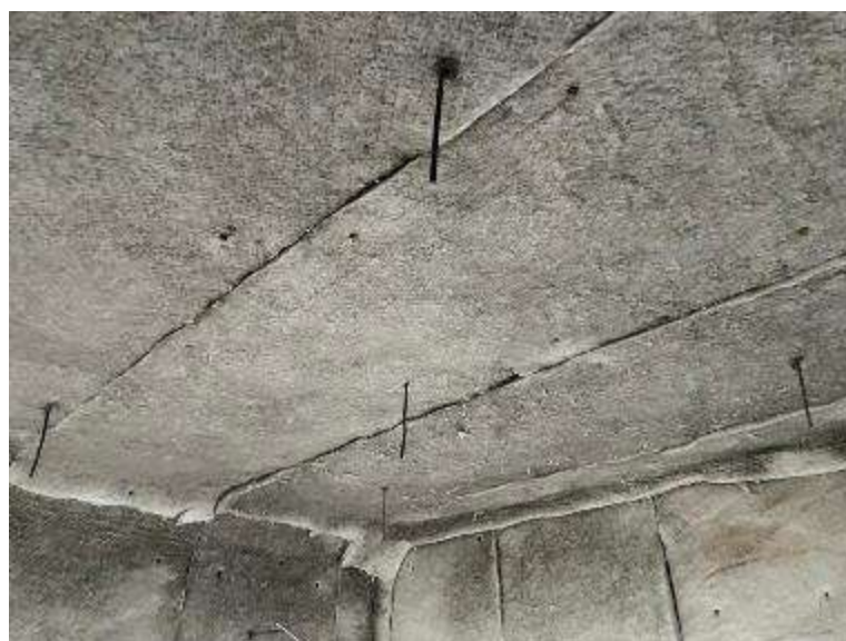
Fotografia 4 – Posicionamento dos termopares TP #19 ao TP #23
