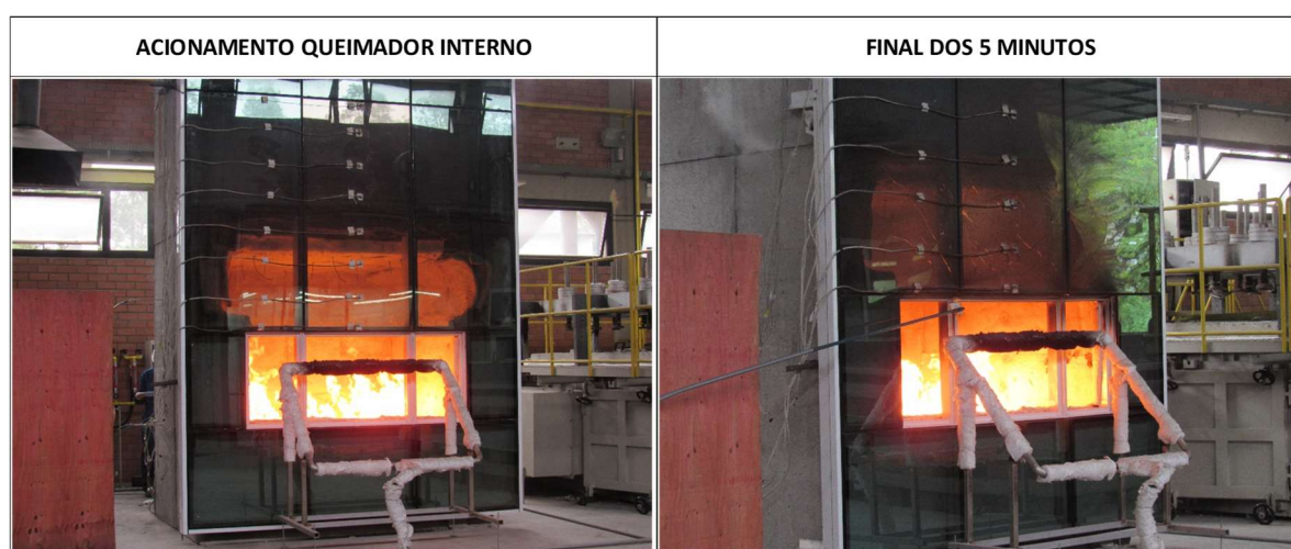
Fotografia 8 - Quebra dos vidros no decorrer dos minutos iniciais do ensaio
