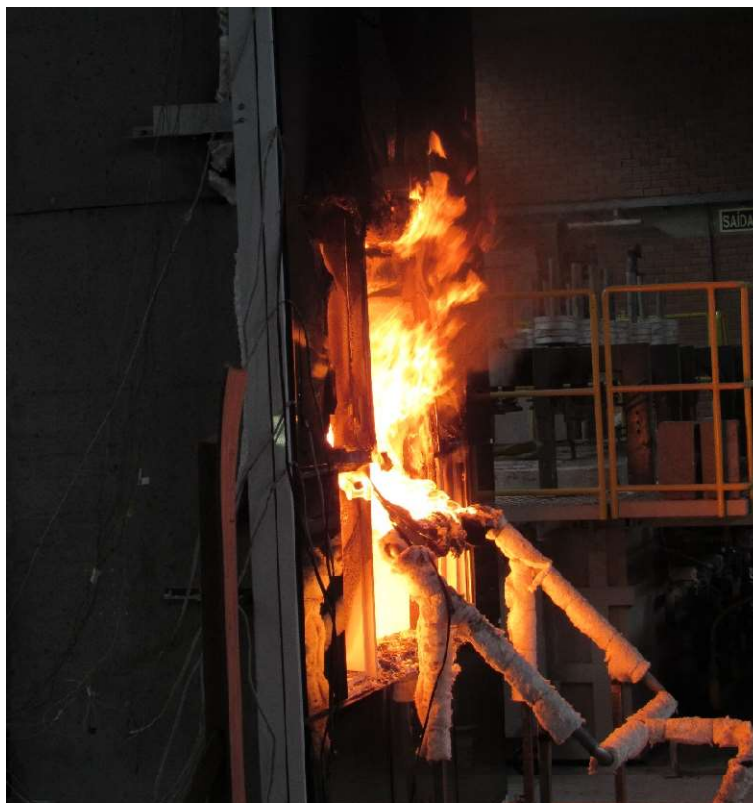
Fotografia 11 – Fogo do queimador externo entrando na sala de testes
