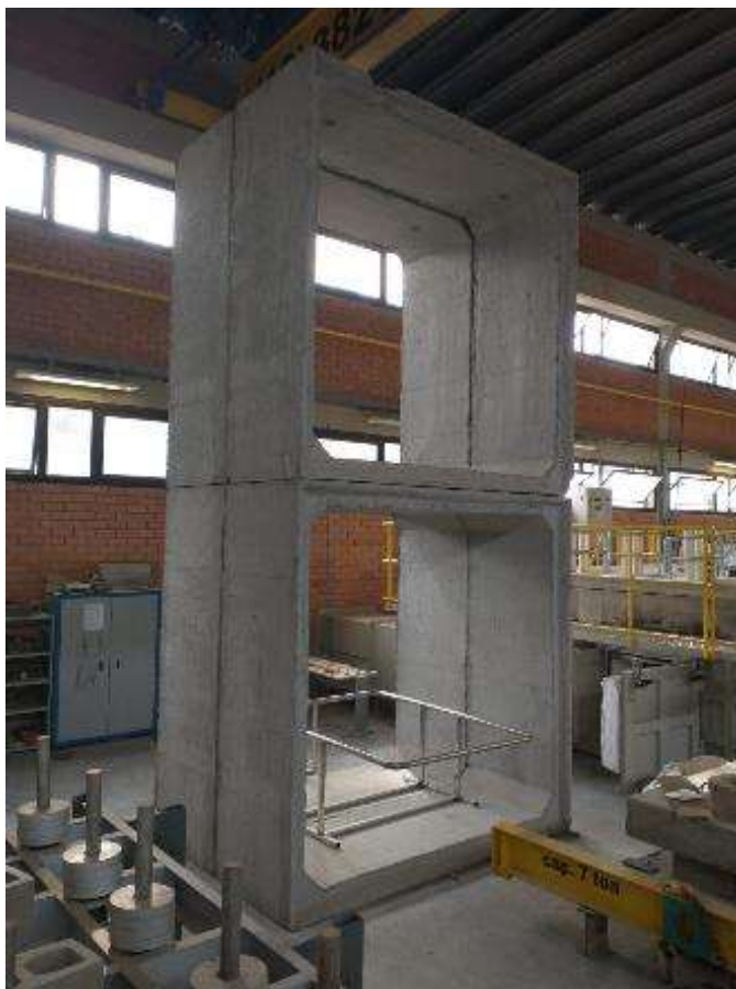
Fotografia 1 – Galerias de concreto armado
