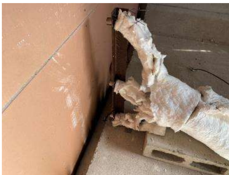
Fotografia 5 – Posicionamento dos sensores de fluxo de calor
