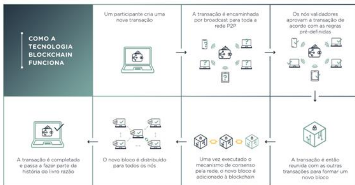
Figura 2 – Funcionamento genérico de uma blockchain
