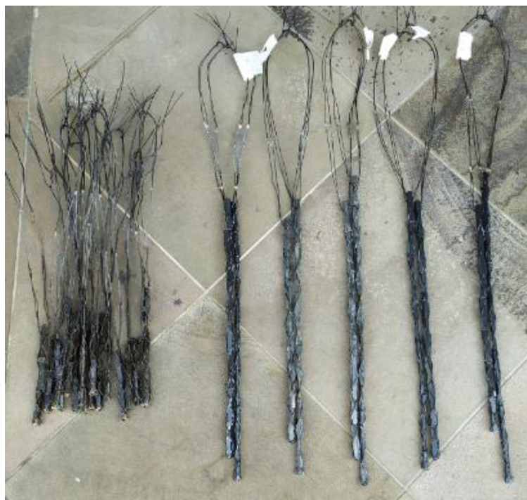
Fotografia 9 – Amarração dos corpos de prova para os tratamentos térmicos
