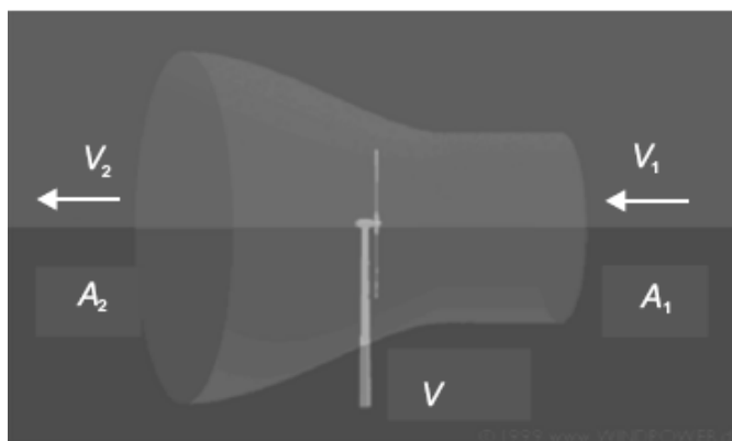
Figura 4 - Fluxo de ar que passa em uma turbina eólica
