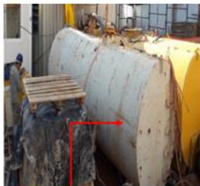
Tanques de armazenamento e preparo do polímero, estabilizante utilizado para conter o solo na escavação com o clamshell .
