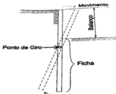
Figura 2 - Condição escoramento em balanço
