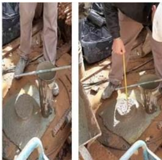
Fotografia 11 - Etapas do slump test
