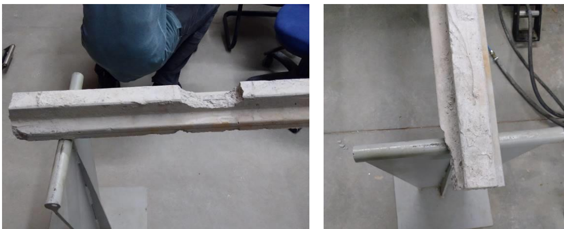
Figura 43 – Defeitos de extração da vigota 2 nas suas duas extremidades
