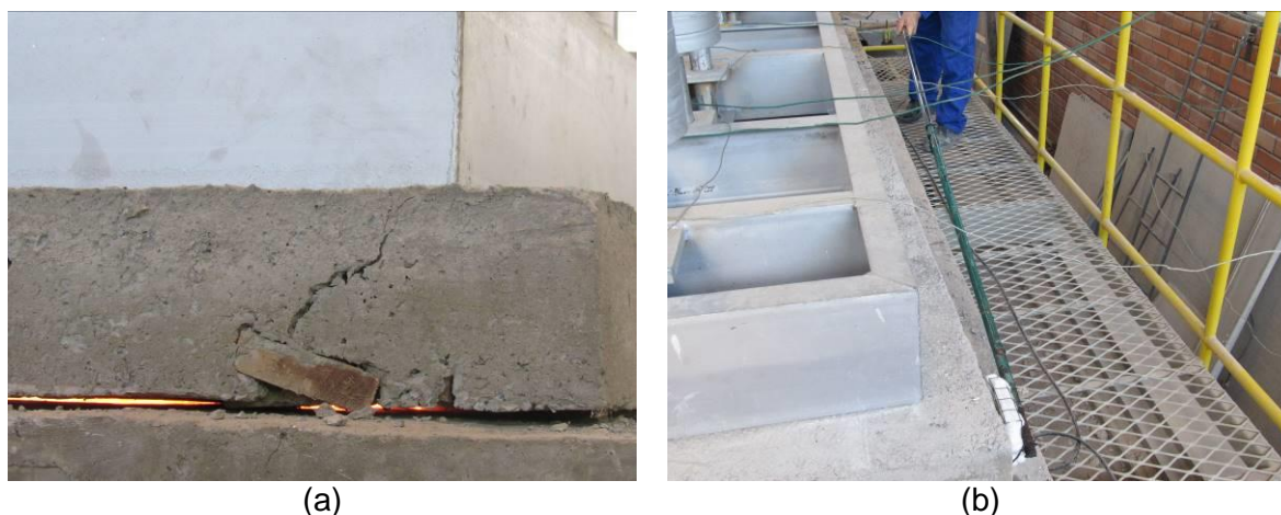
Figura 61 – (a) Configuração da abertura e (b) teste de estanqueidade
