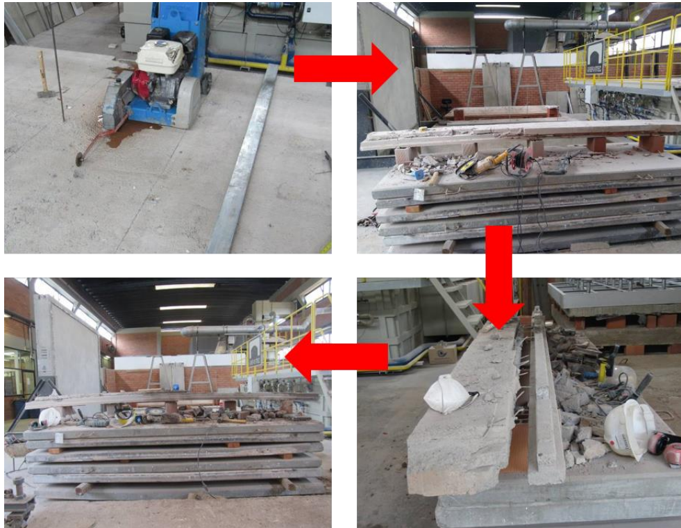
Figura 42 – Processo de extração das vigotas
