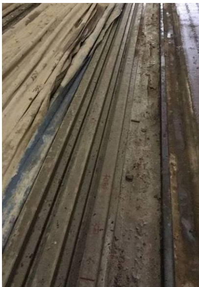
Figura 20 – Vigotas moldadas para os ensaios mecânicos e de resistência ao fogo
