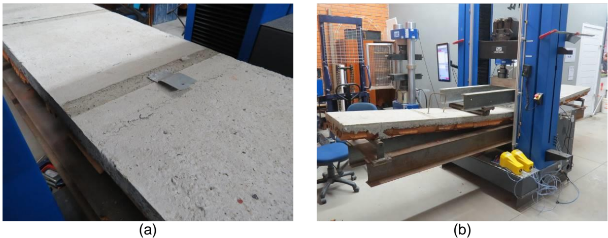
Figura 50 – (a) Configuração das fissuras e (b) aspecto final da amostra
