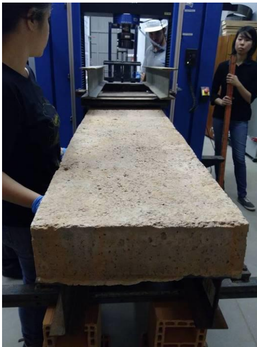
Figura 46 – Posicionamento da nervura pós incêndio no equipamento de carga
