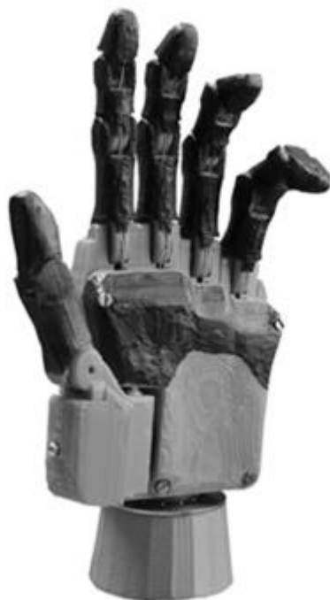
Figura 18 - Prótese Dextrus Hand.
