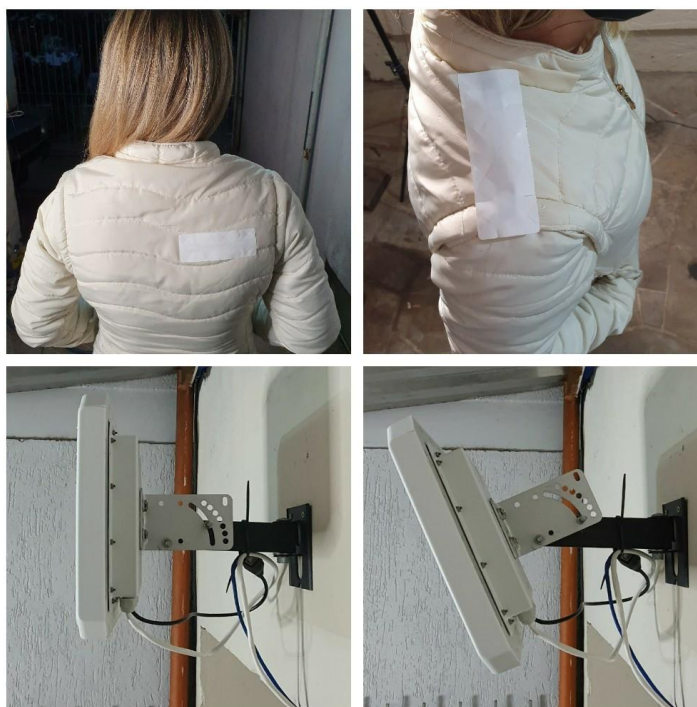
Figura 9: Posições da etiqueta e antena nos testes simulados, a coluna da direita mais eficiente como descrito nos resultados
