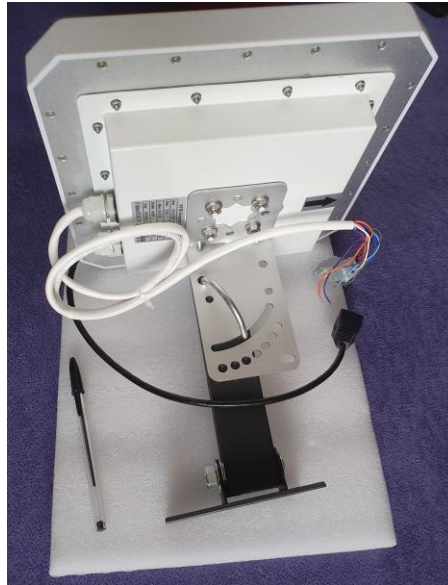
Figura 4 – Montagem da base para a fixação com regulagem
