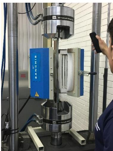
(b) Acoplamento do forno
