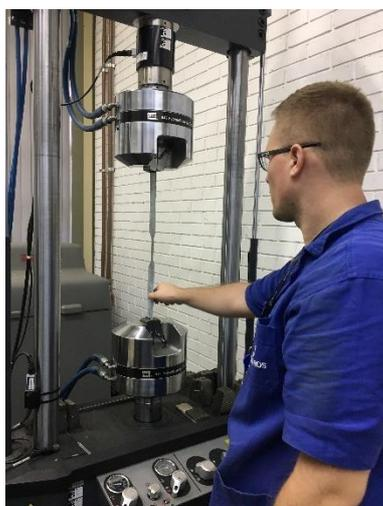
(a) Instalação do corpo de prova
