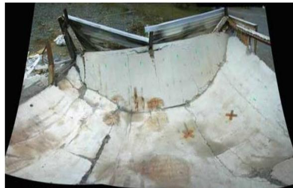
Figura 40 – Lajes mistas com diferentes configurações de vigas ao incêndio
