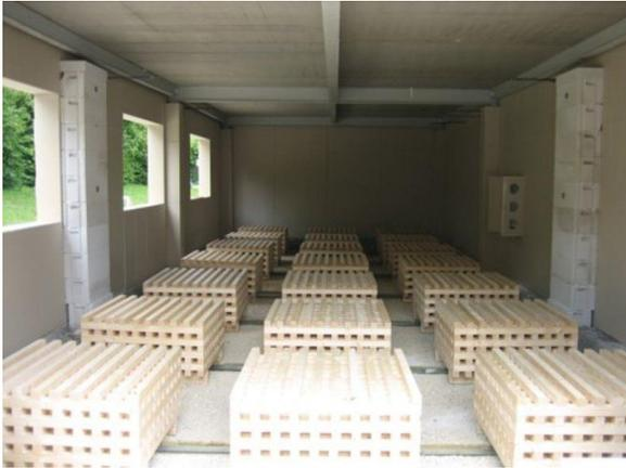
(c) Carga de incêndio para a simulação
