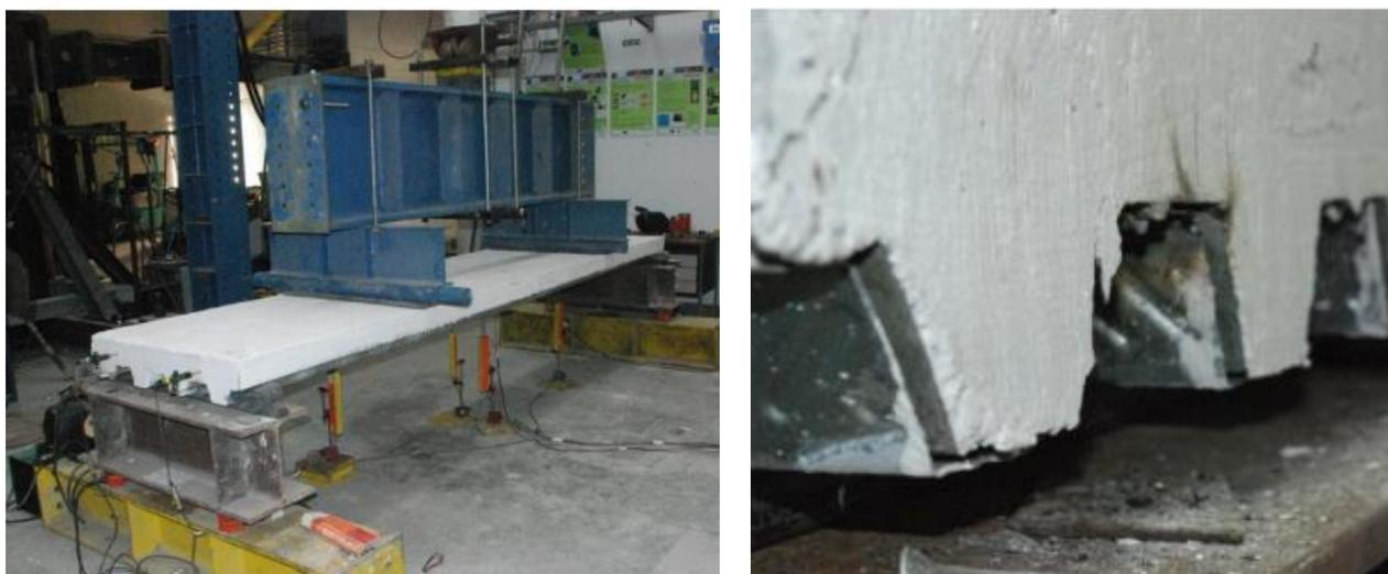
(a) Configuração do ensaio experimental (b) escorregamento relativo chapa-concreto
