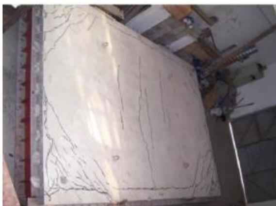
(c) Configuração fissuras no caso das lajes com cobrimento das armaduras de 21 mm
