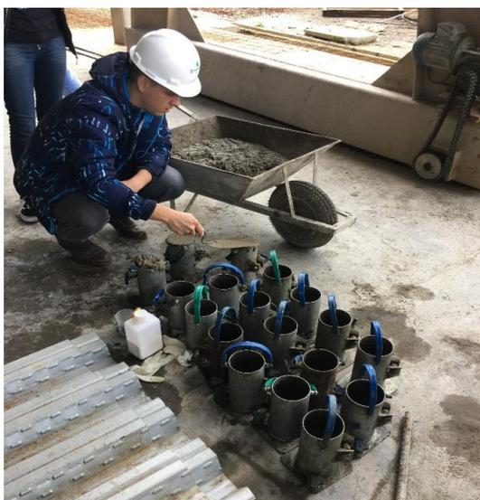
Figura 220 – Moldagem dos corpos de prova
