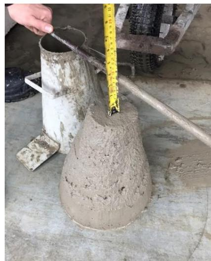
Figura 221 – Procedimento do ensaio de abatimento do concreto
