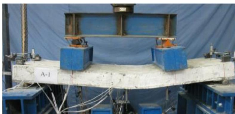
(a) Configuração do ensaio experimental
