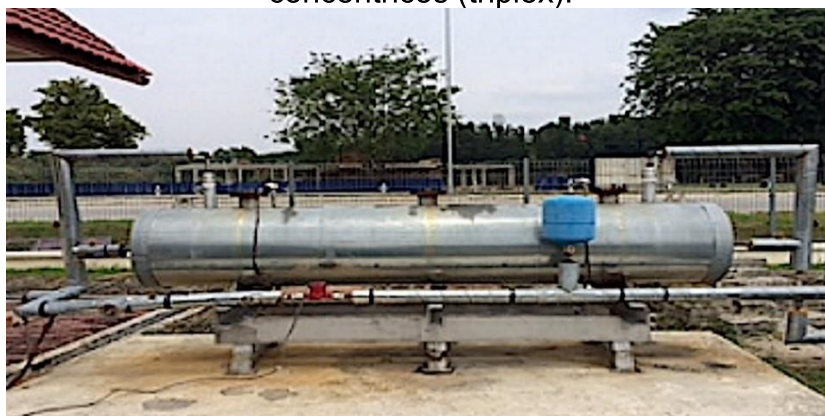
Figura 2.3 – Vista de um armazenador térmico de calor latente de múltiplos tubos concêntricos (triplex).
