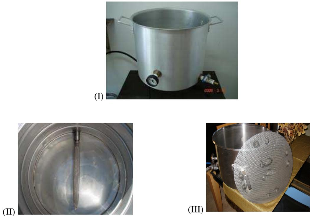
Figura 5: I – Panela de produção de cerveja artesanal; II – Filtração por “Bazooka”; III – Filtração com recipiente de fundo falso
