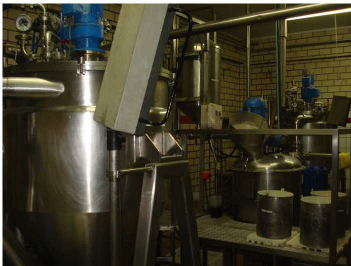
FIGURA 07: Sala de Preparação de Maionese. Máquinas Fryma 500 à frente e Fryma 300 ao fundo.
