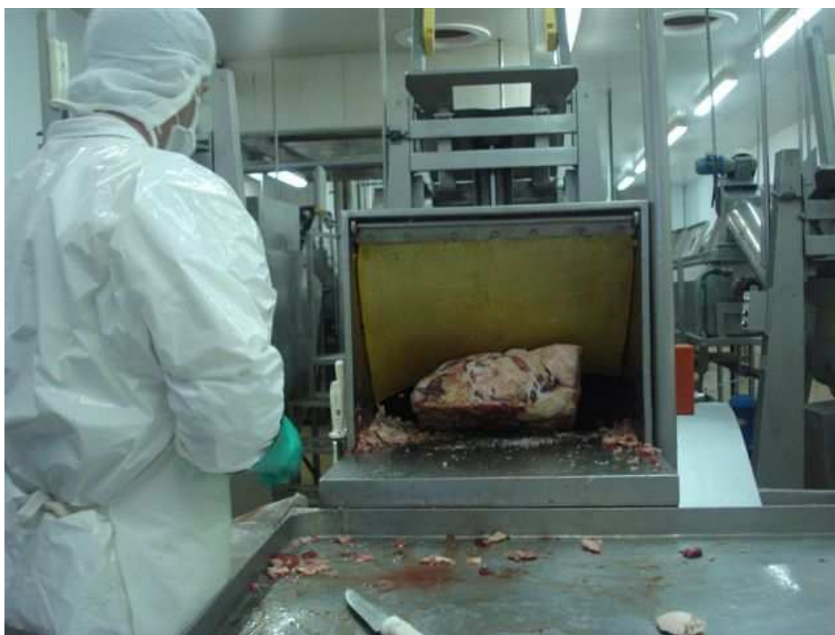
FIGURA 3: Quebrador de blocos de carne na Conserva 3 FONTE: Autor
