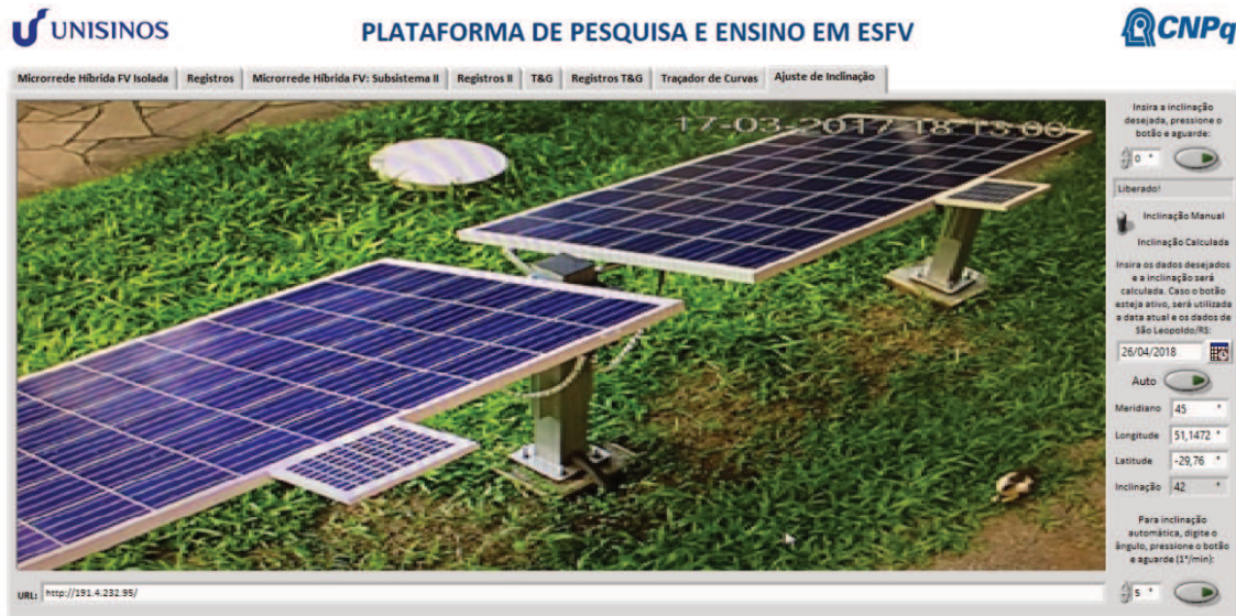
Figura 4.7 - Tela de ajuste da inclinação.
