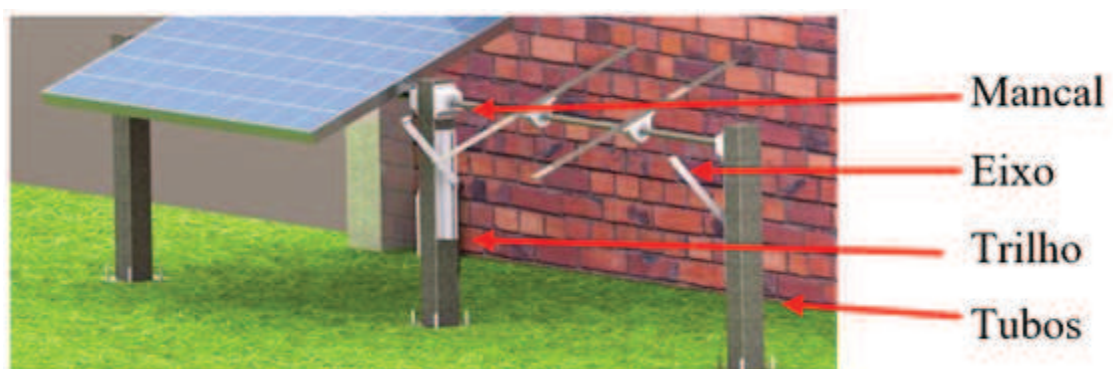
Figura 3.17 - Identificação das partes mecânicas.
