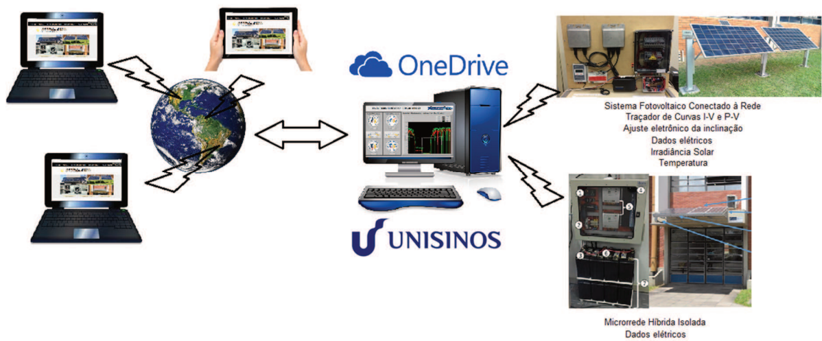
Figura 3.24 - Diagrama de ilustração da plataforma.
