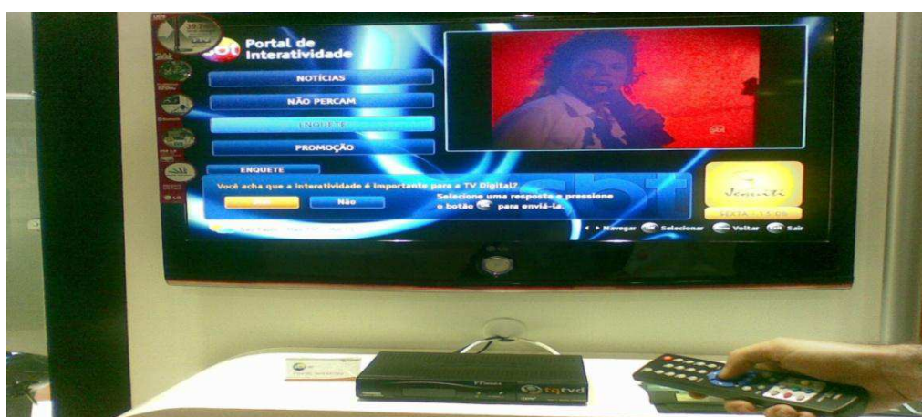
Foto 31 – Registro mostra que todos os controles de navegação são comandados pelas teclas do controle remoto, enviados ao servidor da emissora mediante uma linha de conexão Web .
