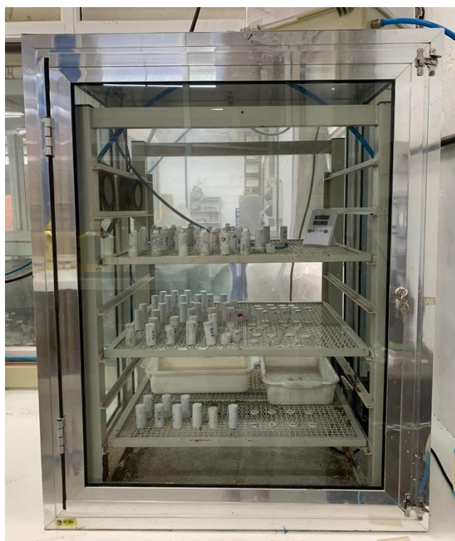
Figura 34 – Amostras inseridas na câmara de carbonatação
