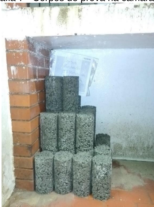
Fotografia 7 - Corpos de prova na câmara úmida.
