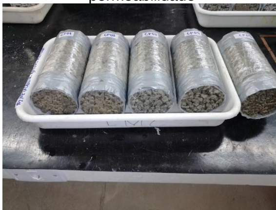
Fotografia 12 - Preparação das amostras para determinação do coeficiente de permeabilidade
