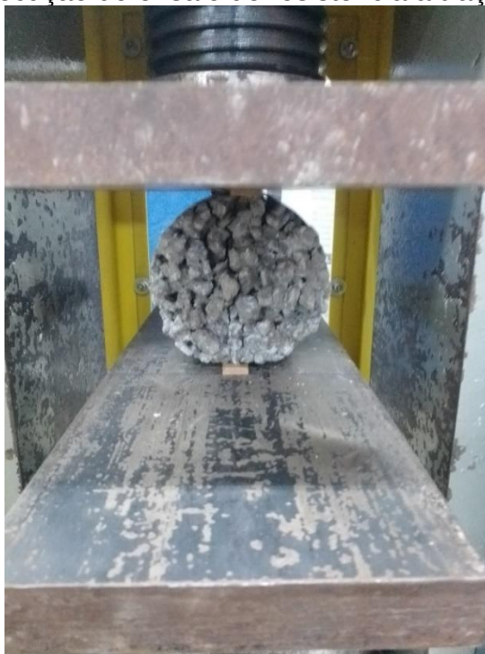
Fotografia 10 - Execução do ensaio de resistência à tração na compressão.
