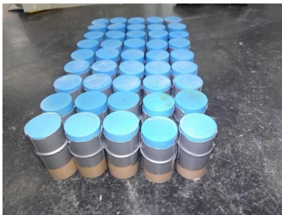
Fotografia 2 - Moldagem das pastas de cimento
