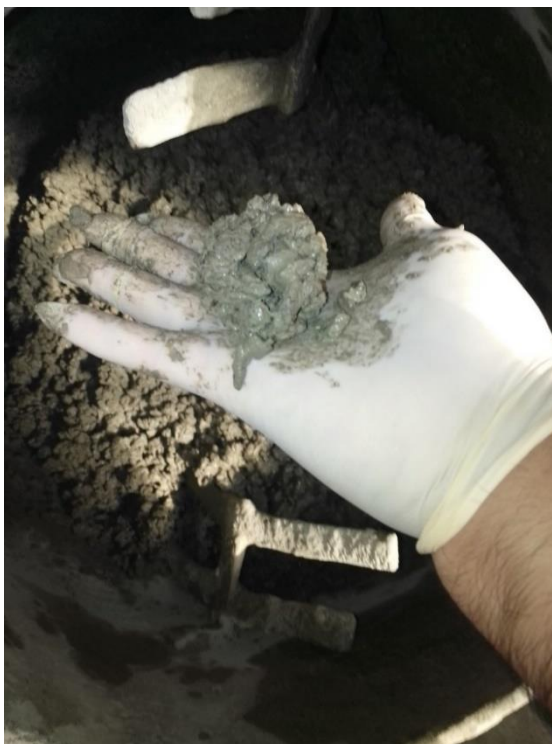
Fotografia 5 - Teste tátil visual do concreto permeável
