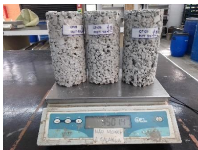
Fotografia 11 - Processo de degradação do concreto permeável por impacto e abrasão.
