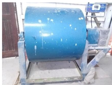
Fotografia 11 - Processo de degradação do concreto permeável por impacto e abrasão.
