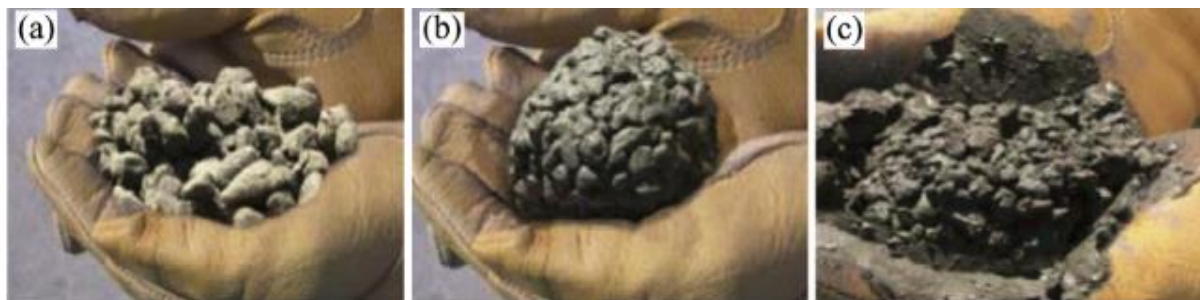
Figura 2 - Teste tátil-visual para controle da consistência da mistura
