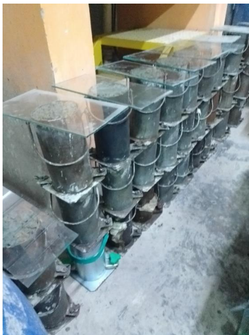
Fotografia 6 - Corpos de prova após a moldagem.
