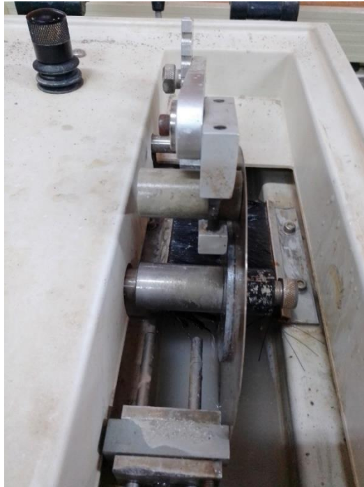
Fotografia 3 - Retificação das faces do corpo de prova.
