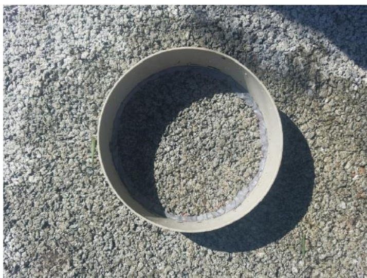
Figura 4 - Equipamento para determinação do coeficiente de permeabilidade para utilização no campo.
