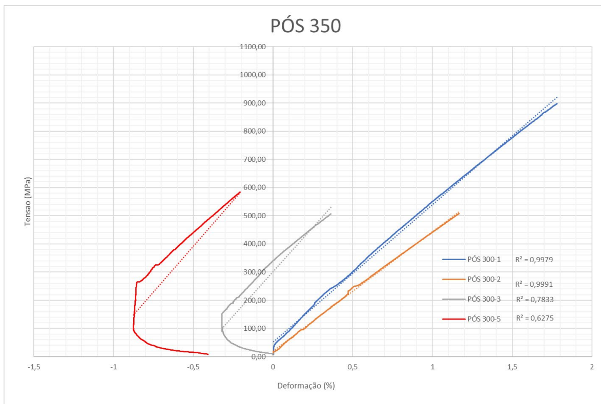
Gráfico C-20: Curva do Módulo de elasticidade (GPa)- Amostras após a exposição à temperatura de 350 °C
