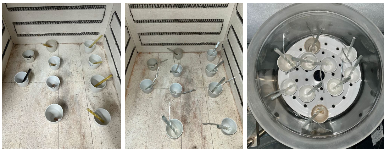
Figura 30: Amostras avaliadas – Etapas de exposição em mufla e amostras no dessecador
