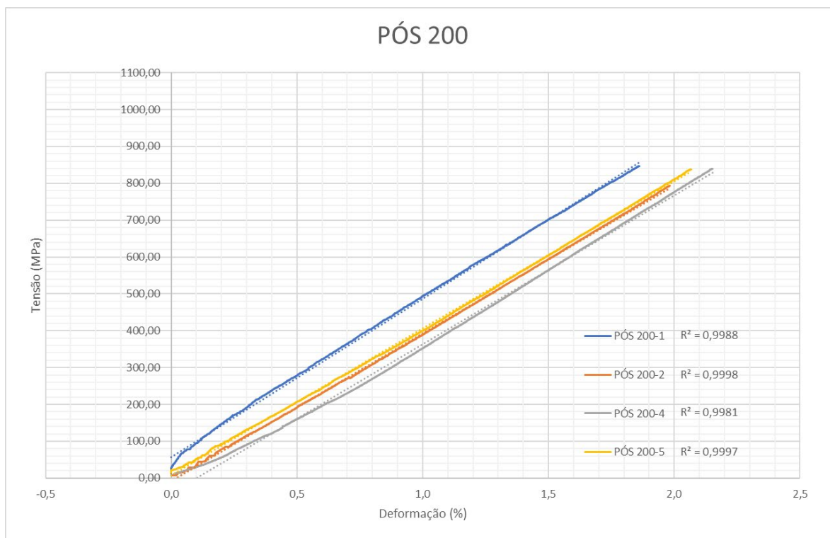
Gráfico C-14: Curva do Módulo de elasticidade (GPa)- Amostras após a exposição à temperatura de 200 °C
