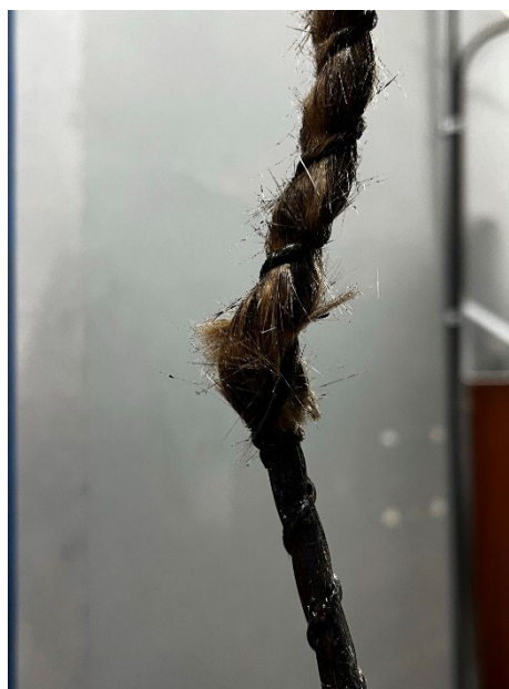
Figura 36: Forma da barra após ensaio de tração axial - Pós temperatura de 350 °C
