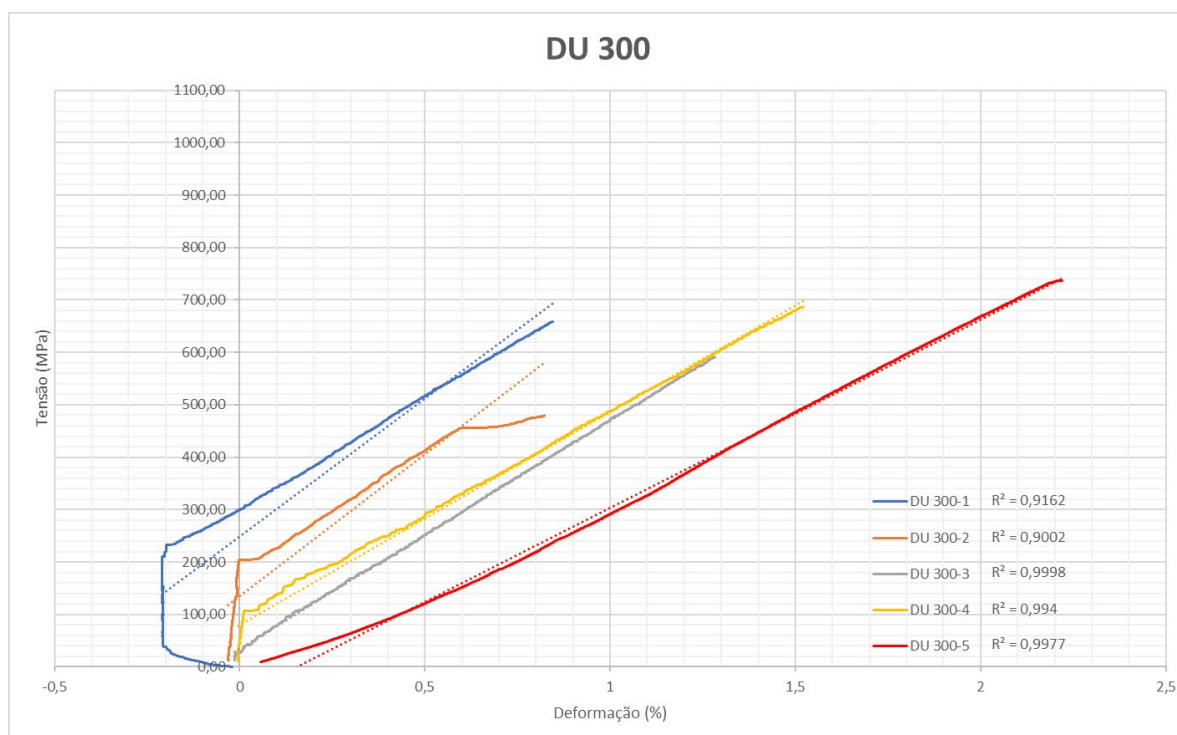
Gráfico C-8: Curva do Módulo de elasticidade (GPa)- Amostras durante a exposição à temperatura de 300 °C
