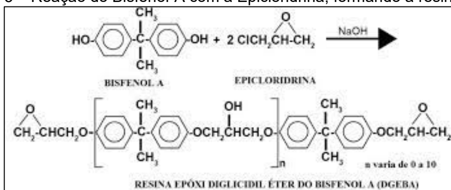
Figura 5 – Reação do Bisfenol-A com a Epiclorigrina, formando a resina epóxi.
