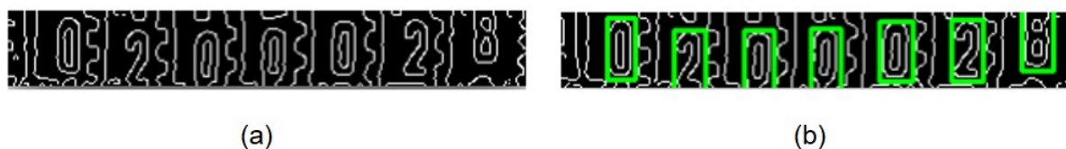
Figura 16 - (a) Aplicação do filtro de Canny. (b) Detecção dos dígitos
