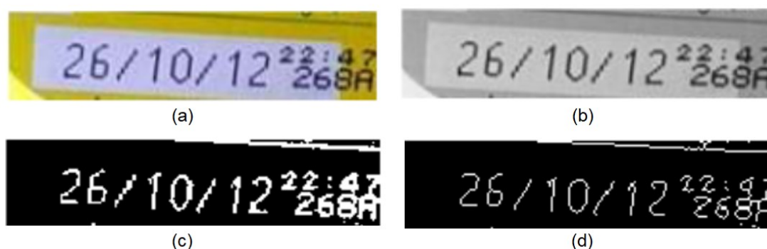
Figura 15 - (a) Imagem original. (b) Imagem em tom de cinza. (c) Imagem binarizada. (d) Imagem com aplicação de operador morfológico
