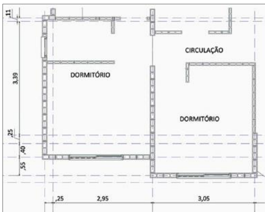
Figura 11 – Modulação horizontal dos blocos.
