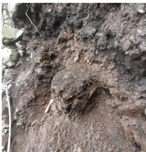
Figura 29 – Escavação realizada para extração de amostra indeformada
