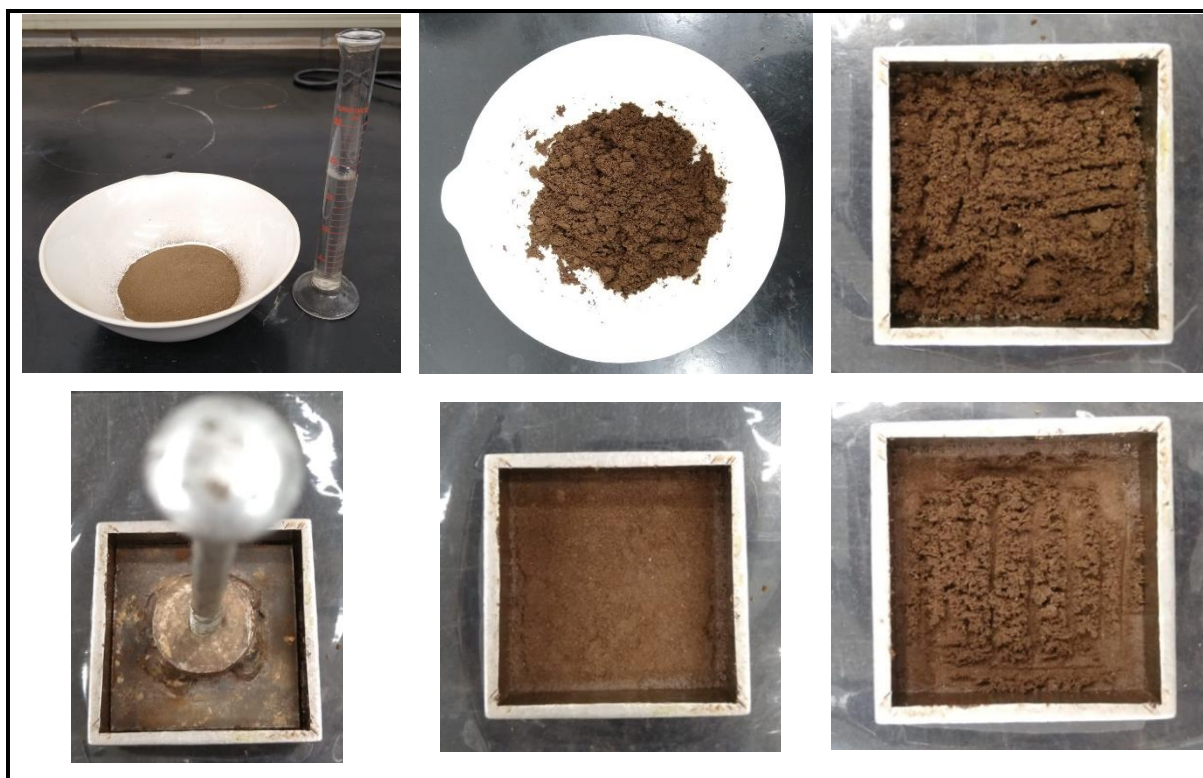
Figura 36 – Etapas do processo de moldagem
