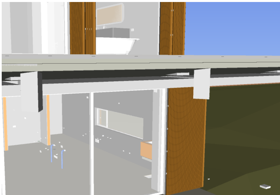
Figura 44– Interferência entre Executivo e Estrutural
