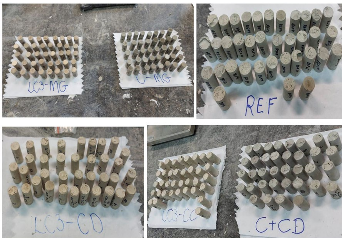
Figura 24 – Pastas após a desmoldagem
